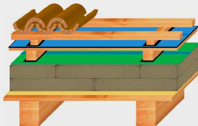
Utilizzo delle membrane DS bituminose come manto impermeabile della copertura; possono essere utilizzati in questo modo solo se posate su un tavolato sopra la ventilazione
