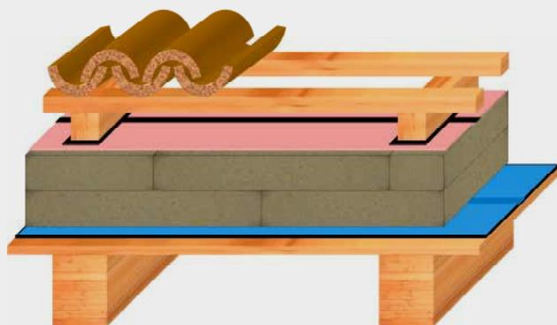
Utilizzo delle membrane DS bituminose come schermo barriera al vapore in copertura sotto il pacchetto coibente
